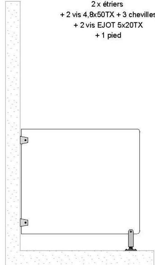
6.2 FIXATION DE L'ÉCRAN SUR CLOISONS STRATIFIÉ COMPACT
